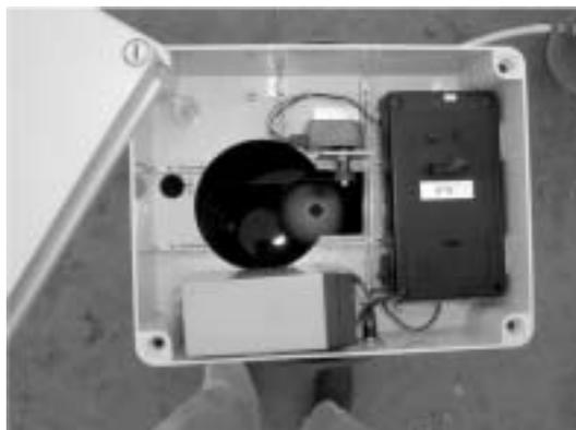
**Fig. 3.**—Caja registradora del descenso del nivel de agua en el depósito compuesta de una boya blanca que reposa sobre el agua del depósito, una polea (en gris) solidaria con el «encoder» (en azul), un circuito electrónico (en negro) y una batería (en gris claro)
