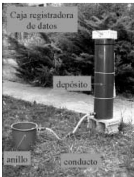
**Fig. 1.**—Componentes principales del Infiltrómetro Automático para la medida de la infiltración del agua en el suelo en condiciones de campo
