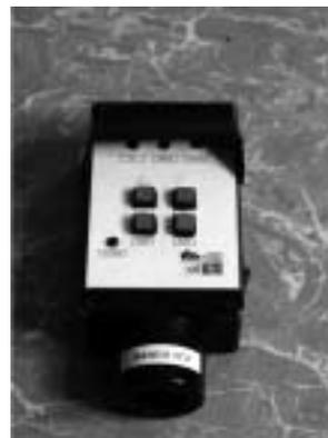
**Fig. 4.**—Mando-registrador portátil con funciones de puesta en marcha y parada del sistema, almacenamiento de los datos de cada IA, y transferencia de los mismos al ordenador
