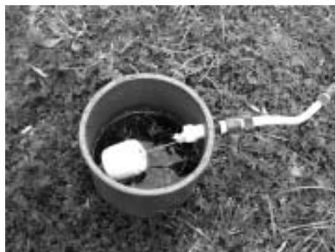
**Fig. 2.**—Anillo de infiltración con el sistema válvula-boya que mantiene un calado constante de agua
